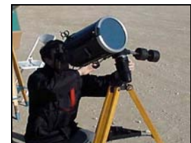
Viséclipse (verre de soudeur grade 14 sur support).
