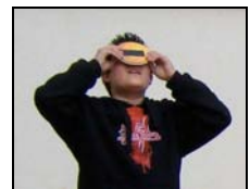
Viséclipse (verre de soudeur grade 14 sur support).
