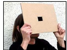
Filtre en polymère fixé solidement sur un carton percé.
